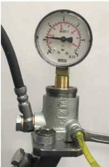
Abbildung 7 und 8: Möglicher Druckaufbau vor dem Entlüften und nach dem Entlüften.
