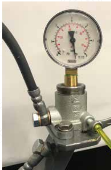
Abbildung 7 und 8: Möglicher Druckaufbau vor dem Entlüften und nach dem Entlüften.
