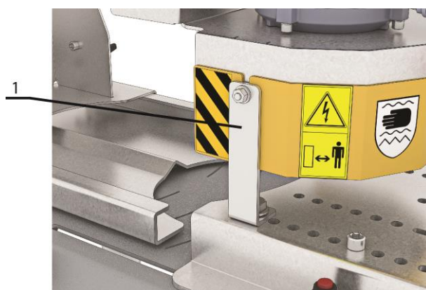
Zng. 9. Schleifmaschine zum Schärfen von Werkzeugen S230 und S400 – Sicherung zur Zeit des Transports (1)
