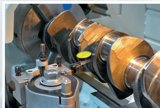
kontrola luzu łożysk osiowych
