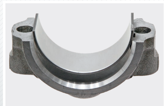
Voorspanning lagerschalen in acht nemen
