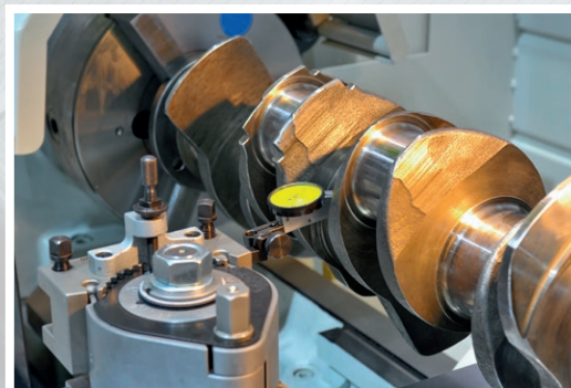
Zkouška vůle axiálního ložiska
