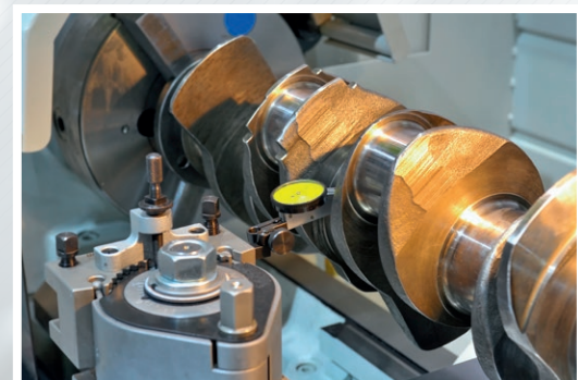
Controle van de axiaalspeling
