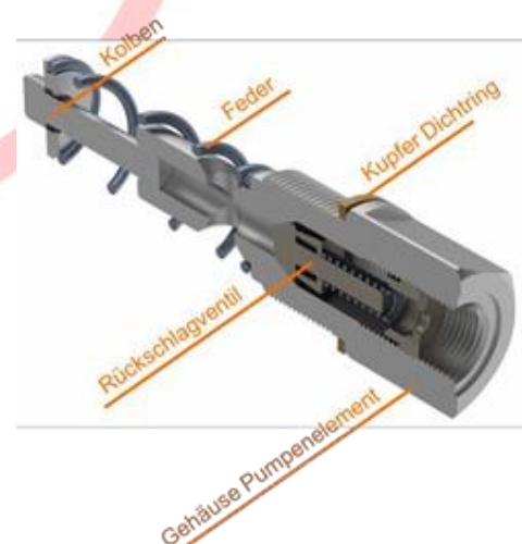
Abb.14.2 Pumpenelement Aufbau
