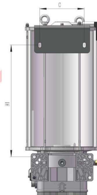
Abb. 11.3 Bei dein Behältergrößen 15L u. 20L sind diese Pumpe auch am oberen Halter am Deckel zu befestigen
