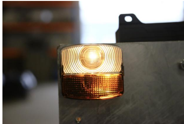
Abb. 28. Kontrollleuchte - Ansicht der aktiven weißen und orangefarbenen Leuchte
