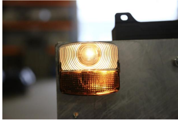
Abb. 39. Signalisiert den geöffneten Schieber der Saugleitung und den geschlossenen Schieber des Rücklaufs
