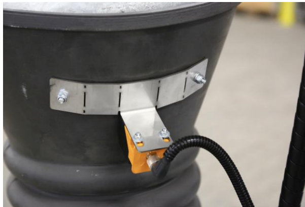
Abb. 5. Anwesenheitssensor des Stahl-Saugrüssels des Tankwagens im Trichter der Andockvorrichtung
