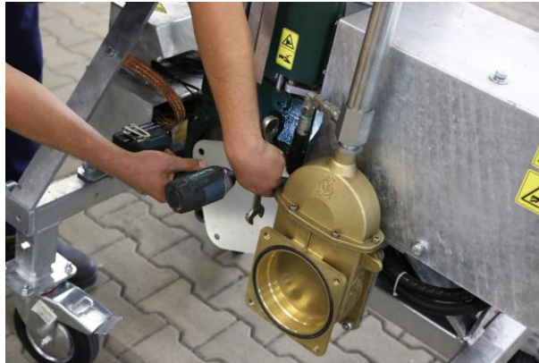
Abb. 17. Stopfen für die Öffnung der Saugleitung abbauen - Ansicht während der Abbaus mit Maulschlüssel oder Steckschlüssel und Schraubendreher
