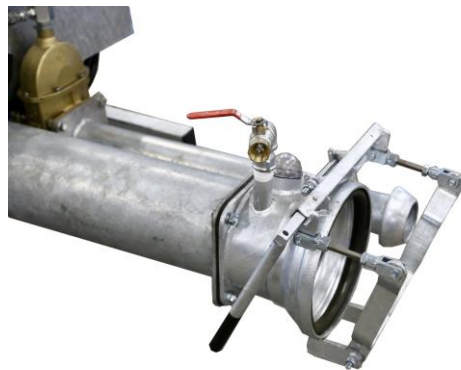
Abb. 36. Schnellkupplung der Saugleitung offen - Hebel abgesenkt
