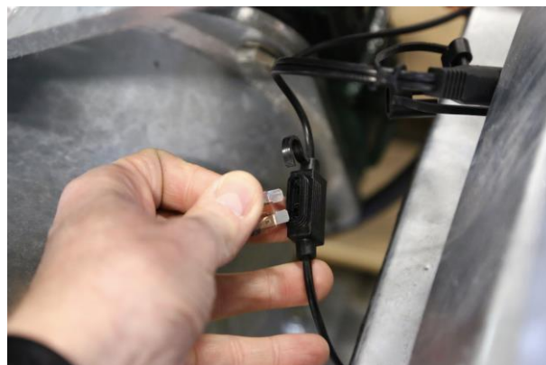
Abb. 10. PKW-Stecksicherung 7,5 A, Ausgangsseite des Batterieladegerät
