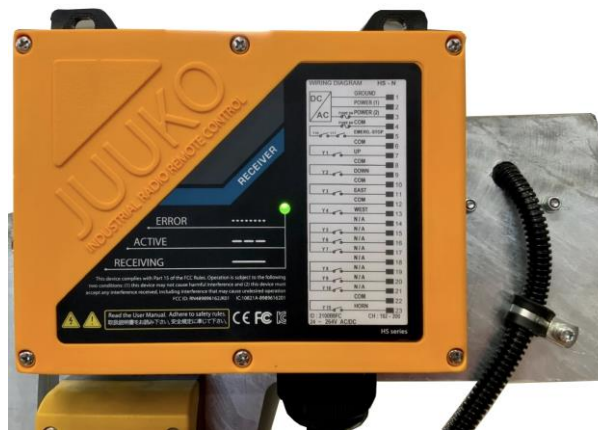
Abb. 26. Grüne Kontrollleuchte der JUUKO-Steuerung
