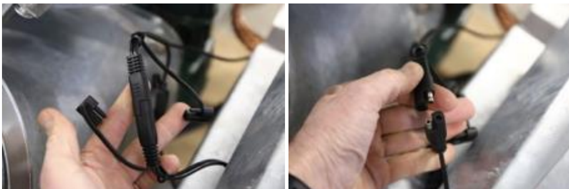
Abb. 9. Doppelanschlussystem Bananenstecker-Buchse, Leitungen an der Ausgangsseite des Ladegerätes zur Batterie - Ansicht der verbundenen und getrennten Teile
