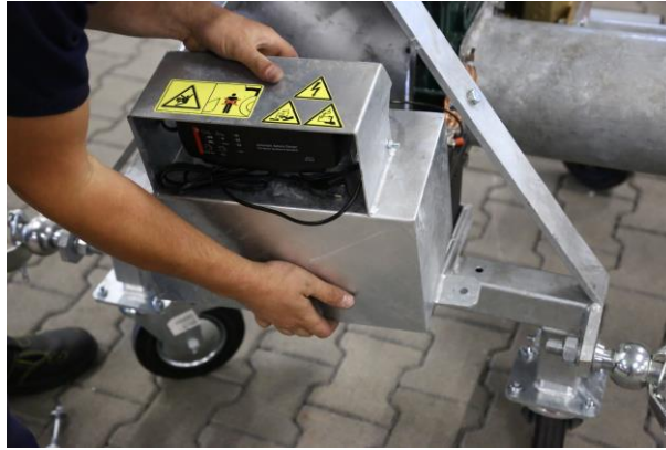
Abb. 45. Abnehmen des abgeschraubten Batteriegehäuses - die Schrauben müssen ausgezogen werden
