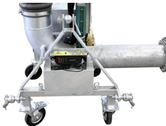
Abb. 32. Dreipunktaufhängung für den vorderen bzw. hinteren Dreipunkt-Kraftheber
