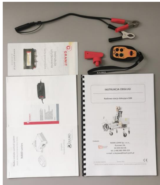
Abb. 14. Werkssatz: Hauptschalterschlüssel und JUUKO-Funkfernbedienung, Richtklemmen, Stationshandbuch
