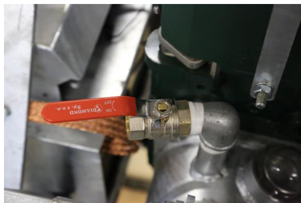
Abb. 40. Entlüftungsventil in geöffneter Stellung
