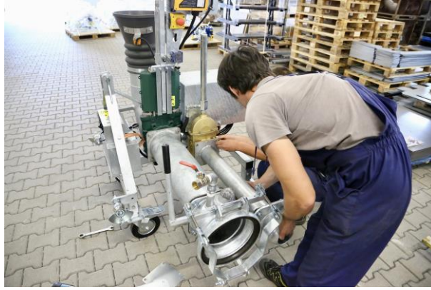
Abb. 22. Montage der Verlängerung des Rücklaufs
