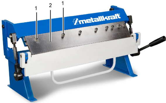
Abb. 5: De-/Montage der Biegesegmente
