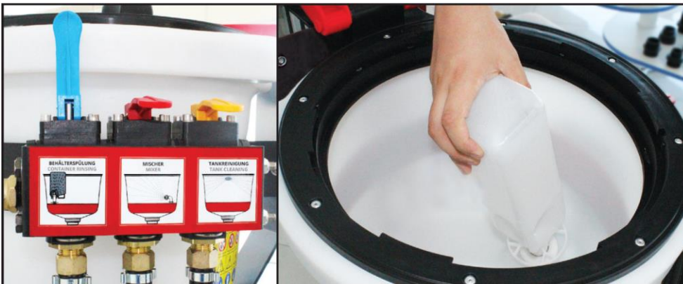
Abb. 6 Chemikalie (Pestizid) Spülung des Behälters
