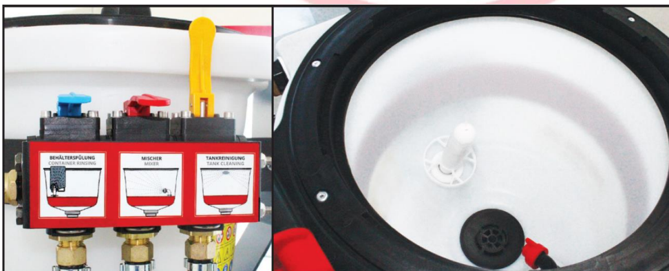
Fig. 7 Nettoyage du réservoir
