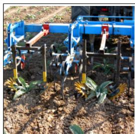
Die Fingerhacke kann in alle gängigen Hackmaschinen eingebaut werden. Hier franz. System in Artischocken
