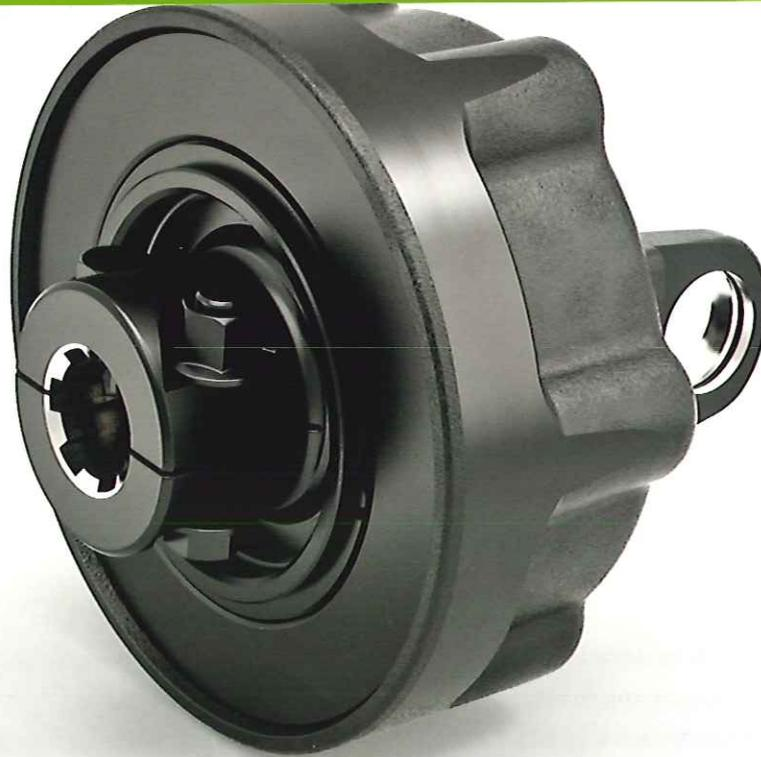
*Die integrale Nockenschaltkupplung unterbricht den Kraftfluss bei Überlastung und schaltet diesen wieder automatisch ein bei einer definierten niedrigeren Drehzahl. Während der Loslösung lässt der patentierte Entwurf keine schädlichen Drehmomentspitzen oder Hitzeentwicklung zu*
